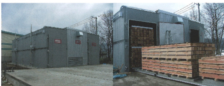
高周波・高温蒸気複合乾燥機 2基 乾燥容量 40 m 3 最高温度 120℃
