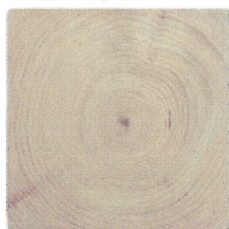
人工乾燥材の断面 (背割りなし)
