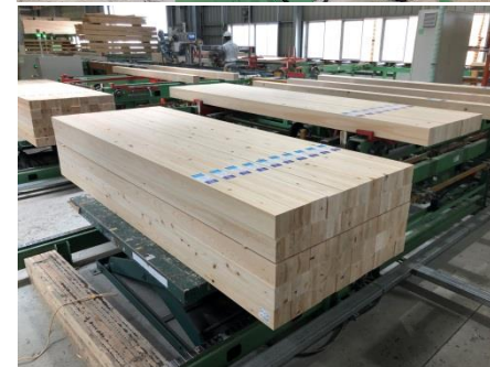
(左上)高周波プレス／(右上)回転プレス ※木材に接着材を塗布して貼り合わせる装置
