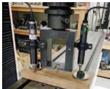
ネジ引き抜き試験風景
