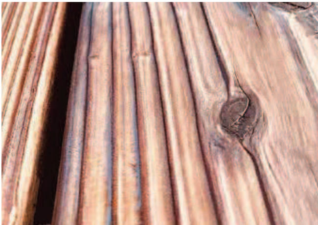
屋外に暴露されて自然に凸凹形状になったスギの無垢材
