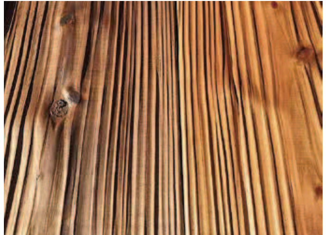
杉赤身髄芯材を凸凹 Gywood 加工し古色仕上げしたもの(左)と柿渋を塗ったもの(右) 夕陽に照らされた写真
