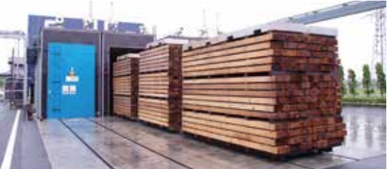
端材を燃料にしたボイラー乾燥機
