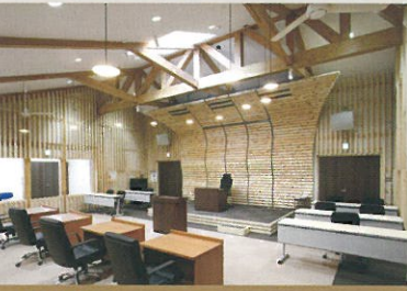
小菅村庁舎 意匠設計：疾測量株式会社 一級建築士事務所 構造概要：木造 +RC 造 3 階建て
